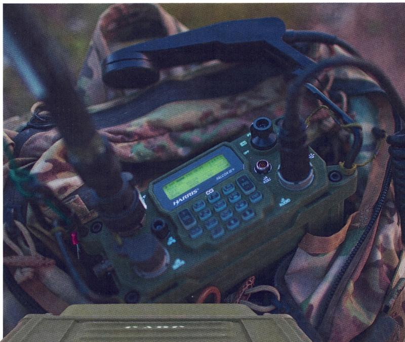
Rechts: Das Falcon III® RF-300H von L3 Harris kam im Jahr 2017 auf den Behördenmarkt. Es ist mit dem Falcon II HF Funkgerät kompatibel. Es ersetzt das US Type 1 AN/PRC-150(C) und überträgt Daten rund zehnmal schneller als seine Vorgänger. Neben Funk verfügt das Gerät über beyond line-of-sight voice and data communication, GPS und Selective Availability Anti-Spoofing Module (SAASM). Ohne SATCOM bzw. moderne HF ist heute eine vernünftige Truppenführung oder Spezialeinsätze kaum noch möglich.
