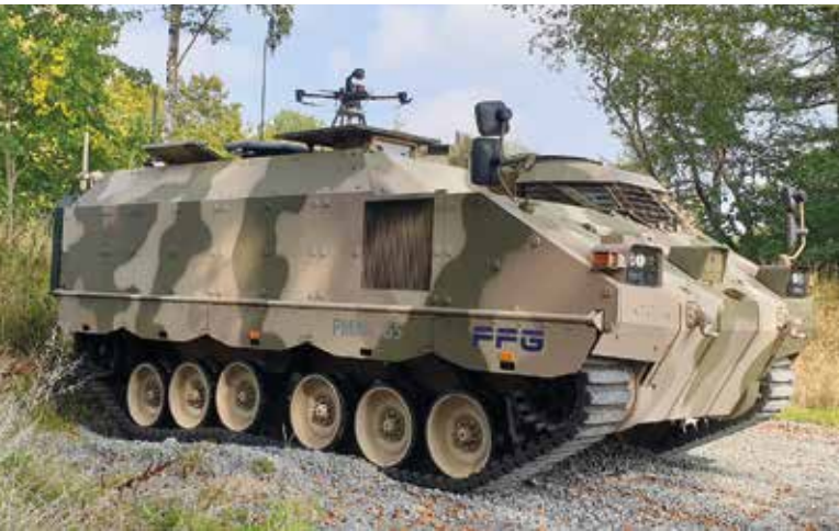
Der FFG PMMC G5 als Gefechtsstandfahrzeug mit angebundener Drohne, um die Kommunikationsreichweite zu erhöhen. (Foto: griffity defense)
