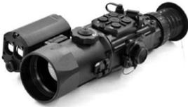
Infrarotzielsystem mit integriertem Entfernungsmesser (Varianten für 700 m oder 1.200 m), mit zusätzlicher Markierungsmöglichkeit, digitalem Kompass und digitalem Neigungsmesser, Darstellung der Ergebnisse auch auf angeschlossenem Monitor oder Smartphone.
