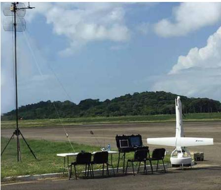
**Abbildung:** V-BAT System mit Bodenstation
